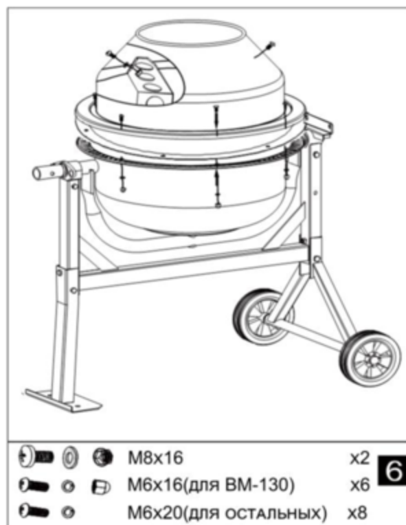
Рис. 11. Установка лопастей и верхнего полубака
